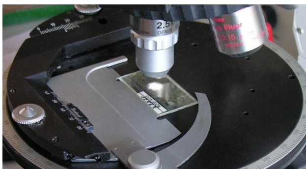
Obr. 3 Výbrus vápenné malty v optickém polarizačním mikroskopu.
